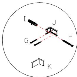
PARA UMA MELHOR FIXAÇÃO NA PAREDE DEVE-SE PRENDER AS DUAS CANTONEIRAS NA PARTE INTERNA DAS LATERAIS.
