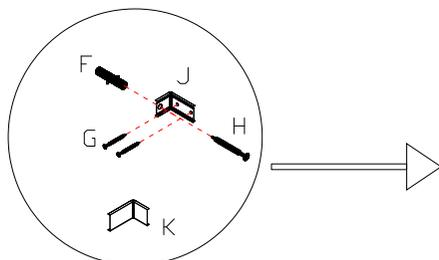
PARA UMA MELHOR FIXAÇÃO NA PAREDE DEVE-SE PRENDER AS DUAS CANTONEIRAS NA PARTE INTERNA DAS LATERAIS.
